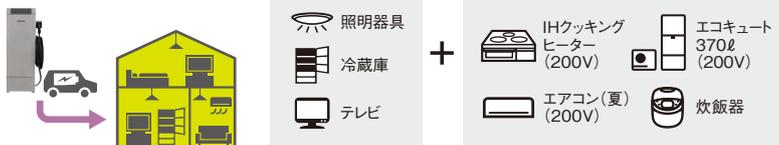
\*4.●停電時、同時に使用可能な電力は合計6.0kVAまで。バックアップ回路のご使用機器全体の消費電力が自立出力より大きい場合は運転を停止します。●エコキュートなど自動運転する機器をバックアップする場合は、夜間などに蓄電池残量がなくなり、パワーステーションが自立運転を停止する場合があります。導入前に機器の自動運転を休止する操作が可能かご確認ください。
