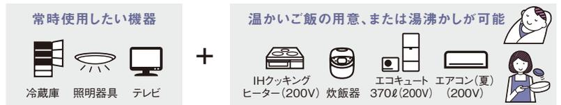
※8.国内の単相タイプの蓄電システムの定格自立出力において(2024年11月29日時点 当社調べ) ※9.蓄電池ユニット(6.4kWh・屋側・一般/耐塩)(6.4kWh・屋側・耐重塩)(6.7kWh・屋内)2台、または、V2Hスタンド設置時。●停電時、同時に使用可能な電力は合計6.0kVAまで。バックアップ回路のご使用機器全体の消費電力が自立出力より大きい場合は運転を停止します。●エコキュートなど自動運転する機器をバックアップする場合は、夜間などに蓄電池残量がなくなり、パワーステーションが自立運転を停止する場合があります。導入前に機器の自動運転を休止する操作が可能かご確認ください。●当社製エコキュートに関しては自立運転時に動作する事を確認しています。停電時に他の機器の使用を優先する場合は自動運転を休止してください。休止中にお湯を沸かす場合は休止設定を解除し手動で沸かしてください。※10.創蓄連携システムS+の蓄電池2台構成との比較。 ※「エコキュート」は関西電力(株)の登録商標です。
