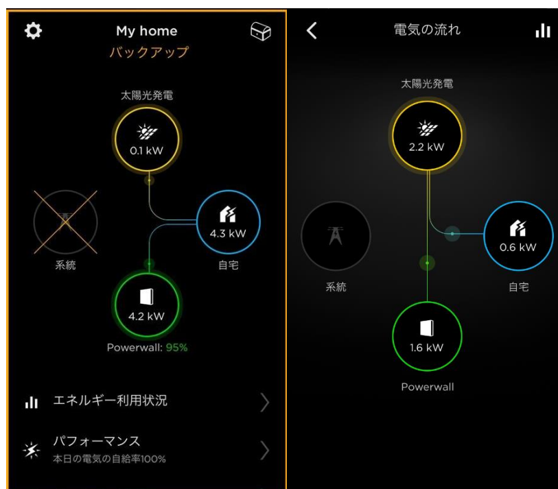
図 4 (左)遮断機が解列している場合は系統が×と表示される、(右)遮断機が投入されている場合は表示されない
