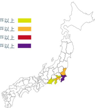
関東地方を中心に2週間以上にわたり最大約93万戸が停電。きわめて強い台風による暴風およびその飛来物による配電設備の故障が相次いだことで、特に千葉県においては被害の範囲が広く、発生から1週間たっても8万戸が停電から復旧しないなど、長期間の停電に直面しました。
