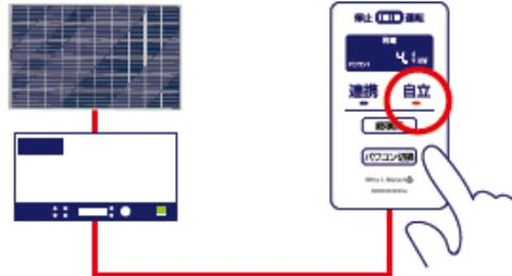
パワーコンディショナーの連携を自立に切り替えれば、自動で電気が供給されます。
