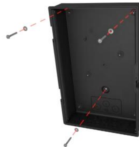
Backup Gatewayの筐体を固定
