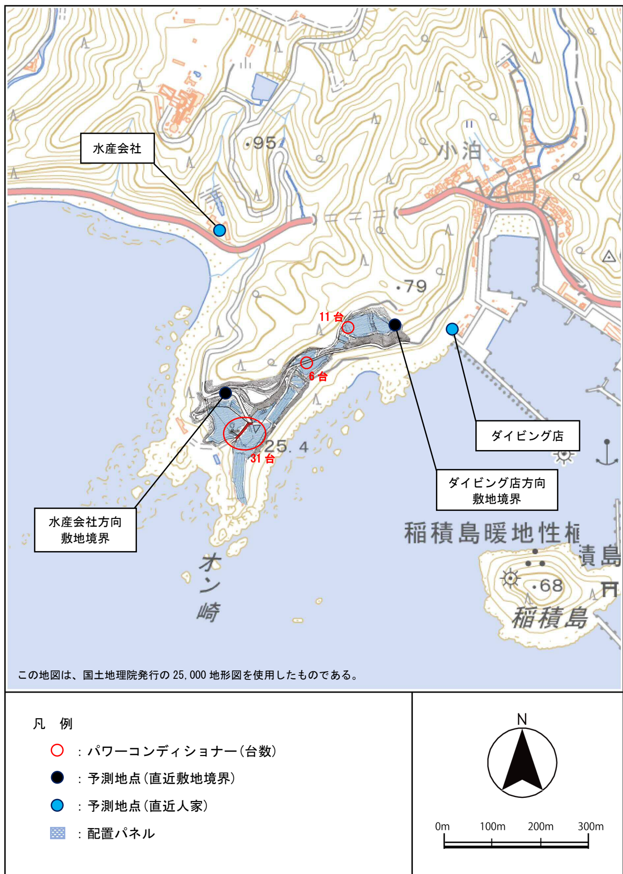
図 5-2-4 設備機器の稼働位置及び予測地点
