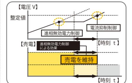
電力系統側の電圧上昇を抑えるために進相無効電力を流します。これにより一時的に系統側の電圧が高まった場合も一定の間、上昇を抑えることができるため売電を持続します。※3
