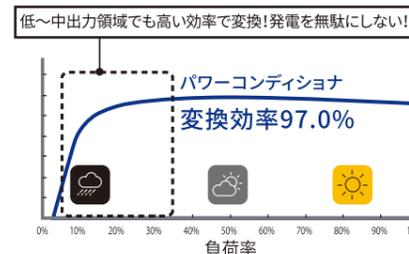
全ての入力回路にMPPT機能を備えているためシステム設計の自由度が高く、変換効率も高い為日陰など悪条件でもパワフルに発電します。
