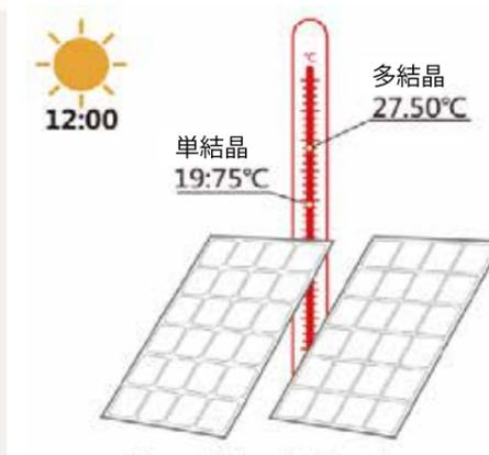
単結晶シリコン太陽電池は、多結晶シリコン太陽電池と比べ結晶構造に起因するロスが少ないため日射による温度上昇が少なくなります。例えば、STC (標準試験条件) 出力が等しい多結晶モジュールとNOCT (公称動作セル温度) を比べると単結晶の方が低い温度になります。単結晶モジュールは多結晶モジュールに対して、温度上昇時の出力低下が少ないことに加え、モジュール温度の上昇自体も少ないため、温度係数の違いを超えたより多くの実発電量を得ることができます。
