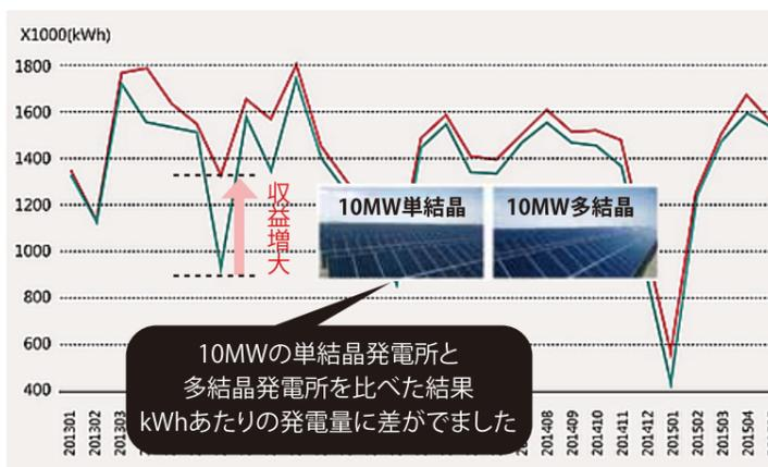
単結晶モジュール10MW発電所と多結晶モジュール10MW発電所の実発電量を比較した実績データです。(中国青海ゴルムド市)
