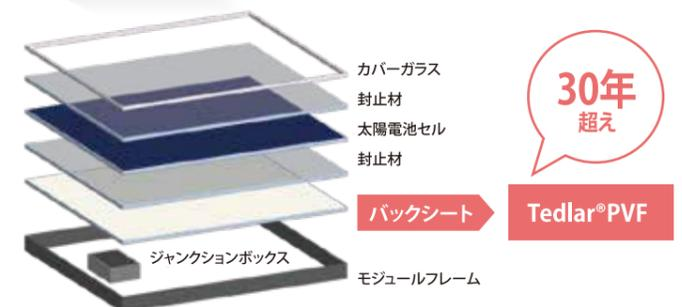
※3 耐UV、耐高温、耐湿、耐化学薬品腐食性および耐機械荷重性にすぐれており砂漠、熱帯、海岸、山岳地域など様々な気候条件での使用を可能としています。
