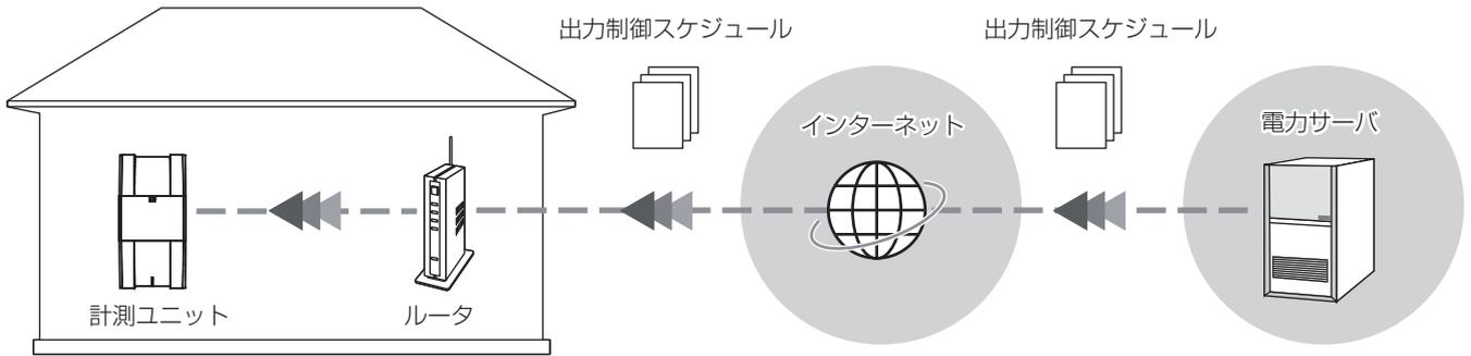
図 1 出力制御 システム構成
