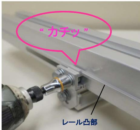
② 徐々にM8×18ボルトを締付けるとサイドプレートがレール凸部に食い込み“カチッ”と音が鳴ります。
