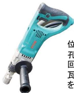
位置決めガイドを足で押さえてセットします。孔開けは、低速回転で位置決めし、その後で回転速度を上げて、孔開けが完了します。瓦を充分乾かした後、孔の周囲にプライマーを塗布してください。
