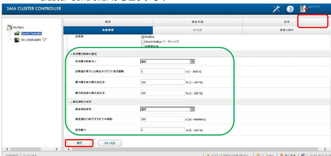
※本項目の通信断絶時の設定は、Cluster Controller と出力制御ユニット間での通信断絶時の設定です。
