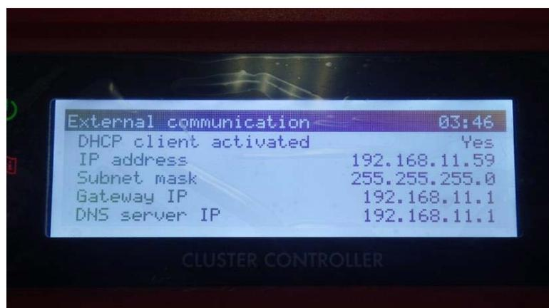
③ ノートパソコンのIPアドレスを Cluster Controller と通信が取れるように変更します。
