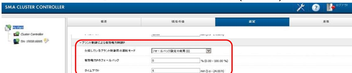
※本項目の通信断絶時の設定は、Cluster Controller とパワーコンディショナ間での通信断絶時の設定です。
