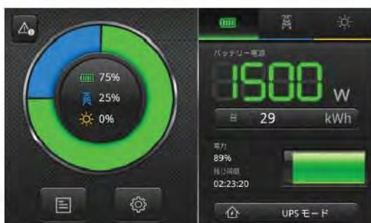
▶▶ 太陽光発電がなく、バッテリー電力が負荷に対して不足しており、系統電力が不足分を供給しています。
