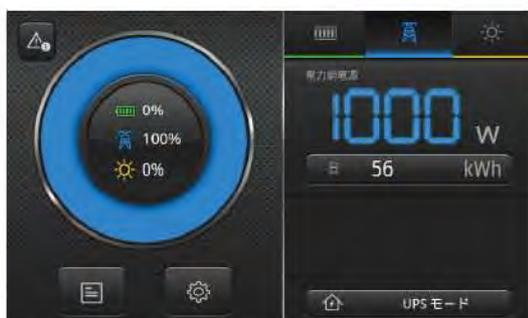
▶▶ 太陽光発電がなく、バッテリーの充電が必要であり、系統電力がバッテリーに蓄電され、現在負荷に対して供給されています。
