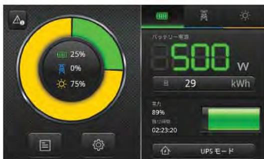
▶▶ 太陽光発電が負荷に対して不足しており、バッテリー電力と系統電力が不足分を供給しています。
