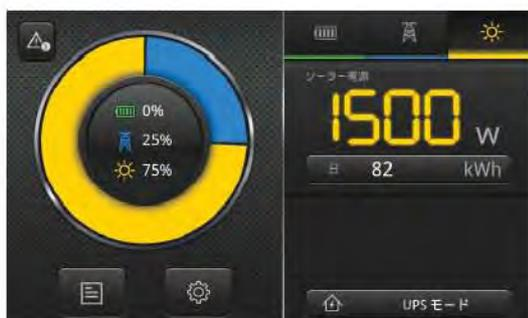
▶▶ 太陽光発電が負荷に対して不足しており、バッテリーもなく、系統電力が現在差分を供給しています。
