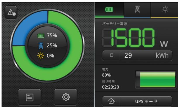
▶▶ 太陽光発電がなく、バッテリー電力が負荷に対して不足しており、系統電力が現在差分 不足分 を供給しています。
